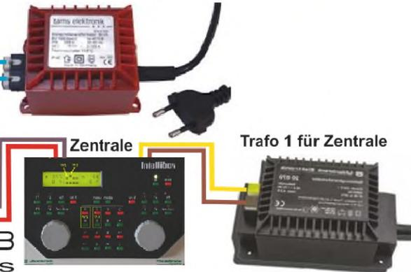
**Hinweis:** die Schaltung bedarf eines eigenen Trafos 2 und darf nicht durch Trafo 1 versorgt werden!
